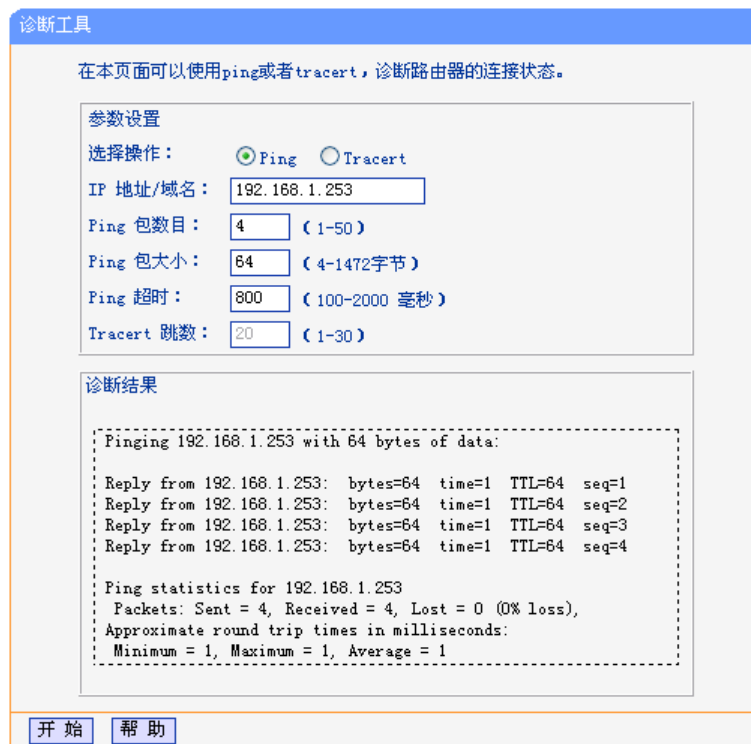
图 6-14 Ping 诊断结果—成功
