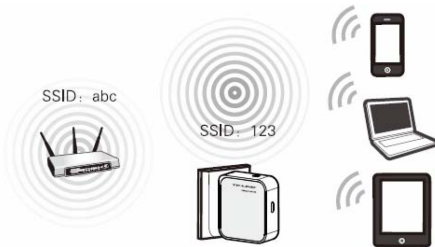
图 4-4 Bridge 模式连接图
