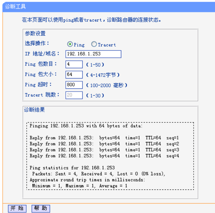
图 9-58 Ping 诊断结果—成功
