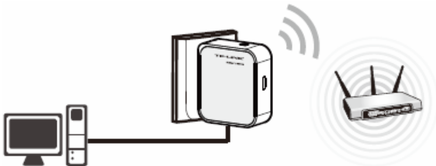
图 4-5 Client 模式连接图
