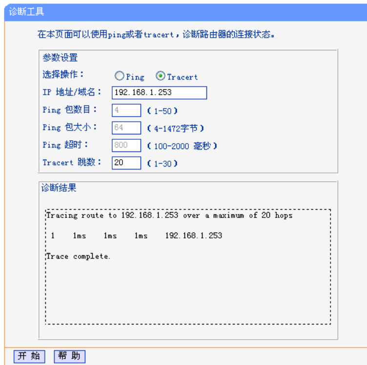
图 5-18 Tracert 诊断结果—成功
